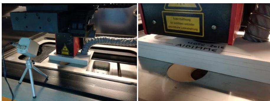
**Figura 20.** Montaje protección del cabezal y tubo de refrigeración
